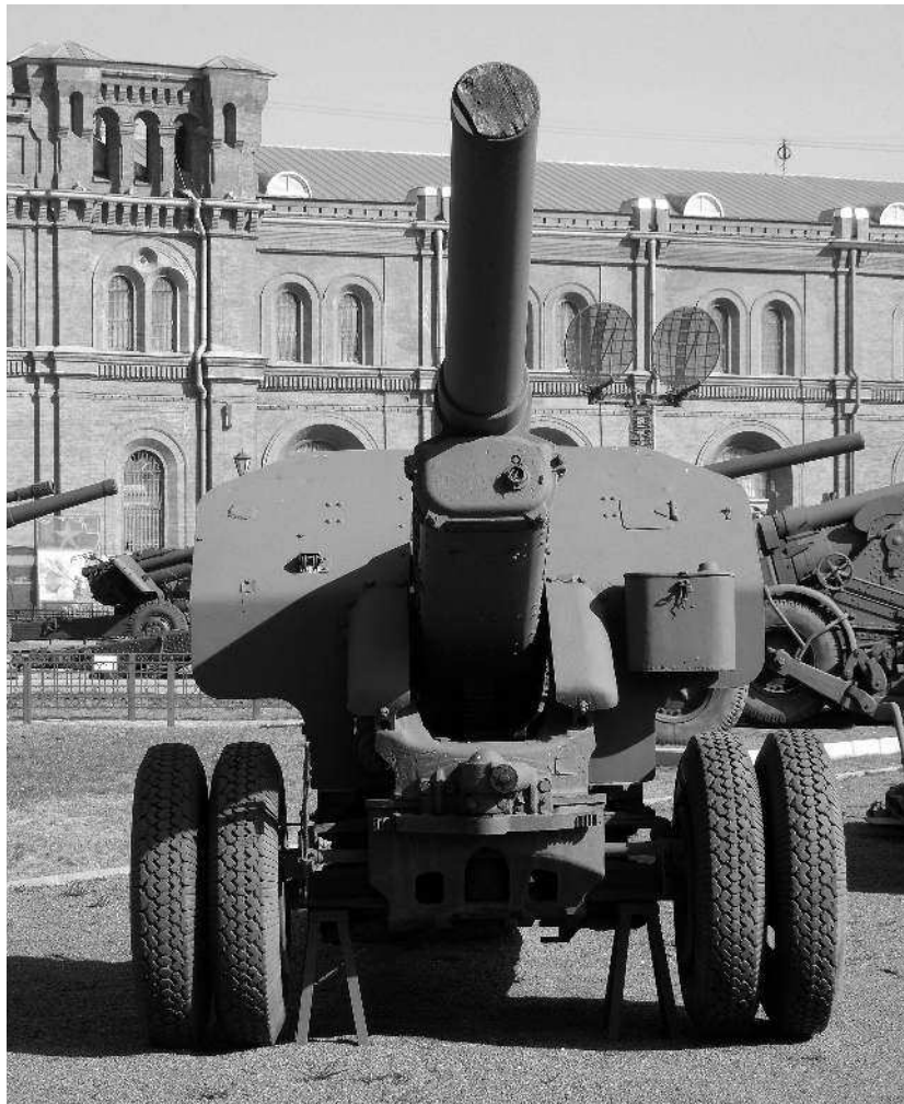
Серийная 152-мм гаубица обр. 1938 г. (М-10) в экспозиции Военно-исторического музея артиллерии, инженерных войск и войск связи, г. Санкт-Петербург.
