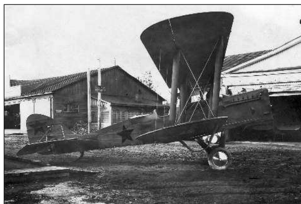
Р-1 с мотором М-5 постройки завода № 1. Фото из архива Г.Ф. Петрова
