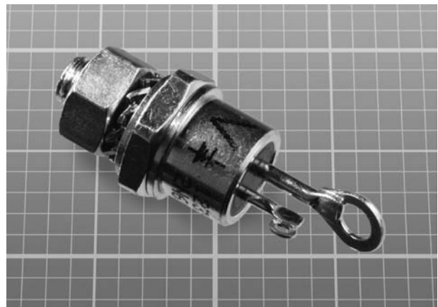
Рис. 1.5. Триодный тиристор штыревой конструкции, выдерживающий в выключенном состоянии напряжение до 50 В со среднеквадратичной силой тока, не превышающей 25 А
